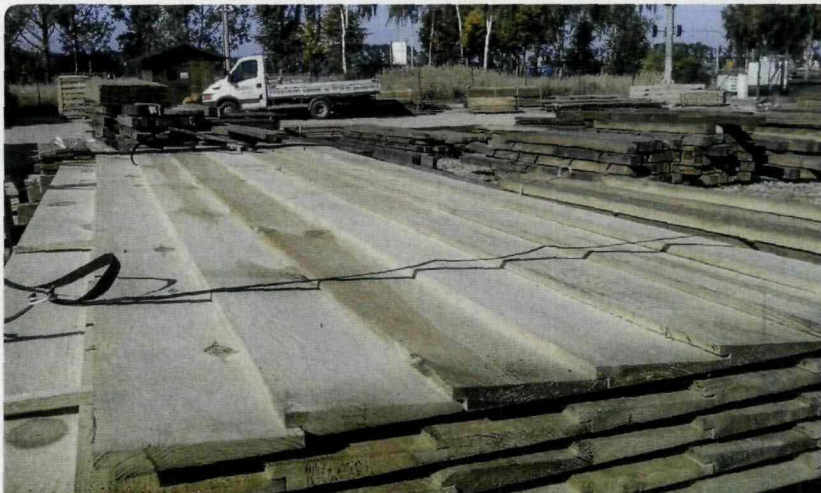
► W tartakach i składach drewna można kupić strugane i profilowane deski elewacyjne. Są dobrze wysuszone, a czasem też zaimpregnowane
